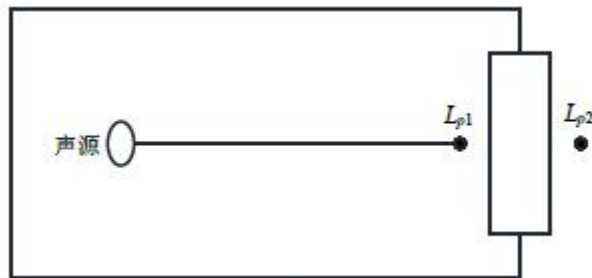
图 4-4 室内声源等效为室外声源图例
